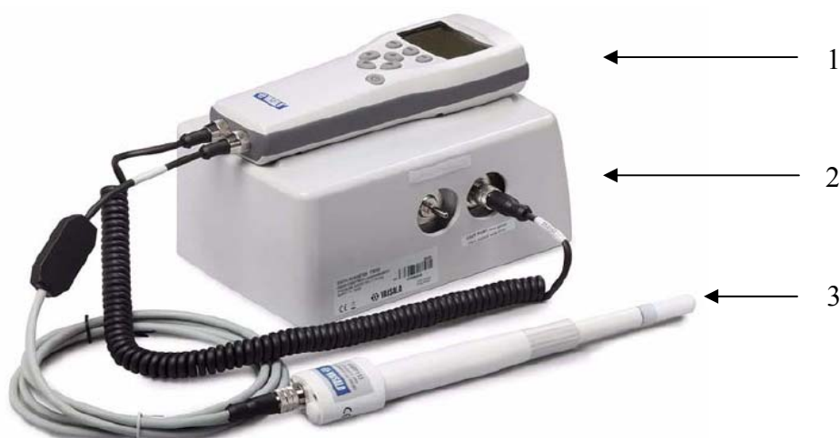
Рисунок 1 - Общий вид барометров РТВ330ТС 1 - ручной индикатор МІ70, 2 - цифровой барометр РТВ330, 3 - преобразователь температуры и влажности НМР155
