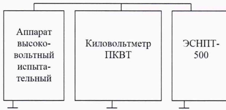
Рисунок 2 - Проверка погрешности измерений напряжения переменного тока свыше 1 кВ
