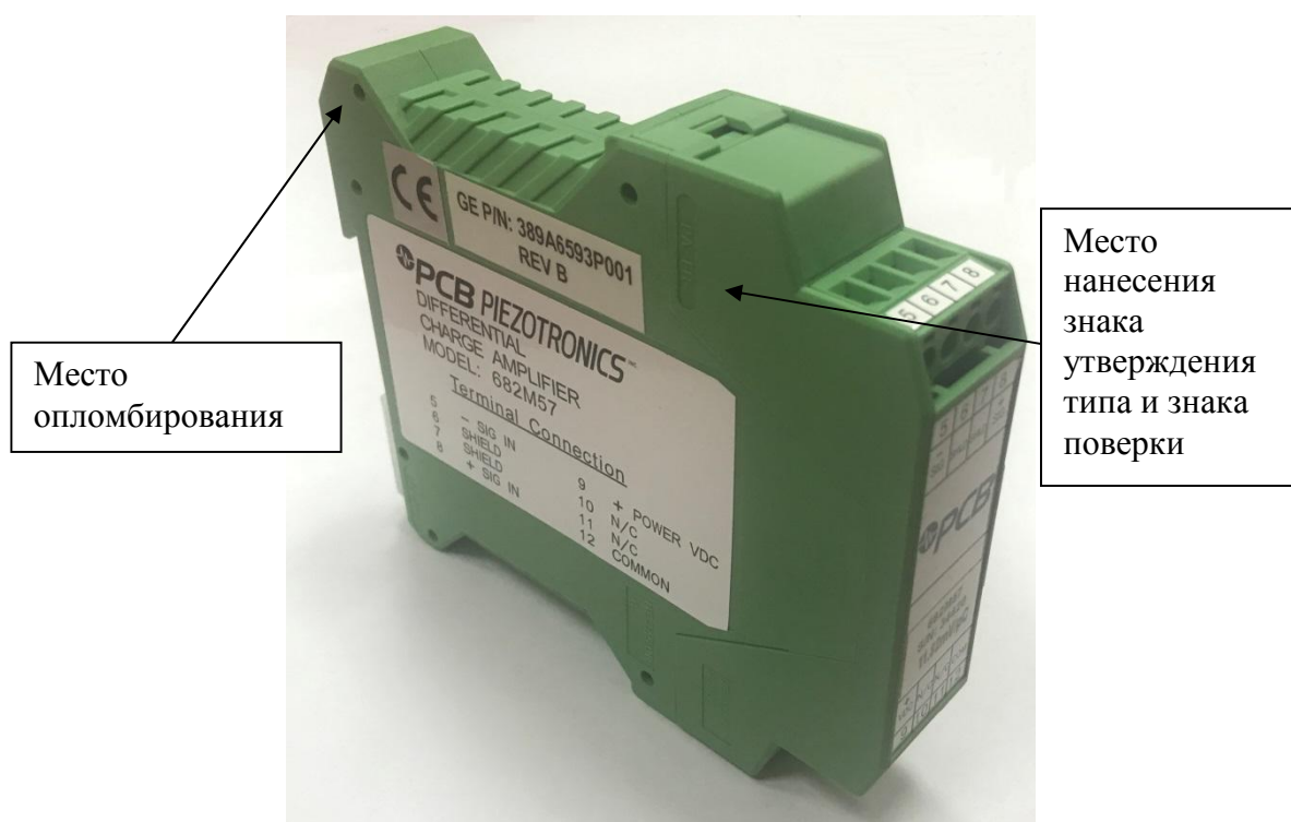
Рисунок 1 - Общий вид, схема пломбировки, обозначение места нанесения знака утверждения типа и знака поверки усилителей заряда модели 682M57
