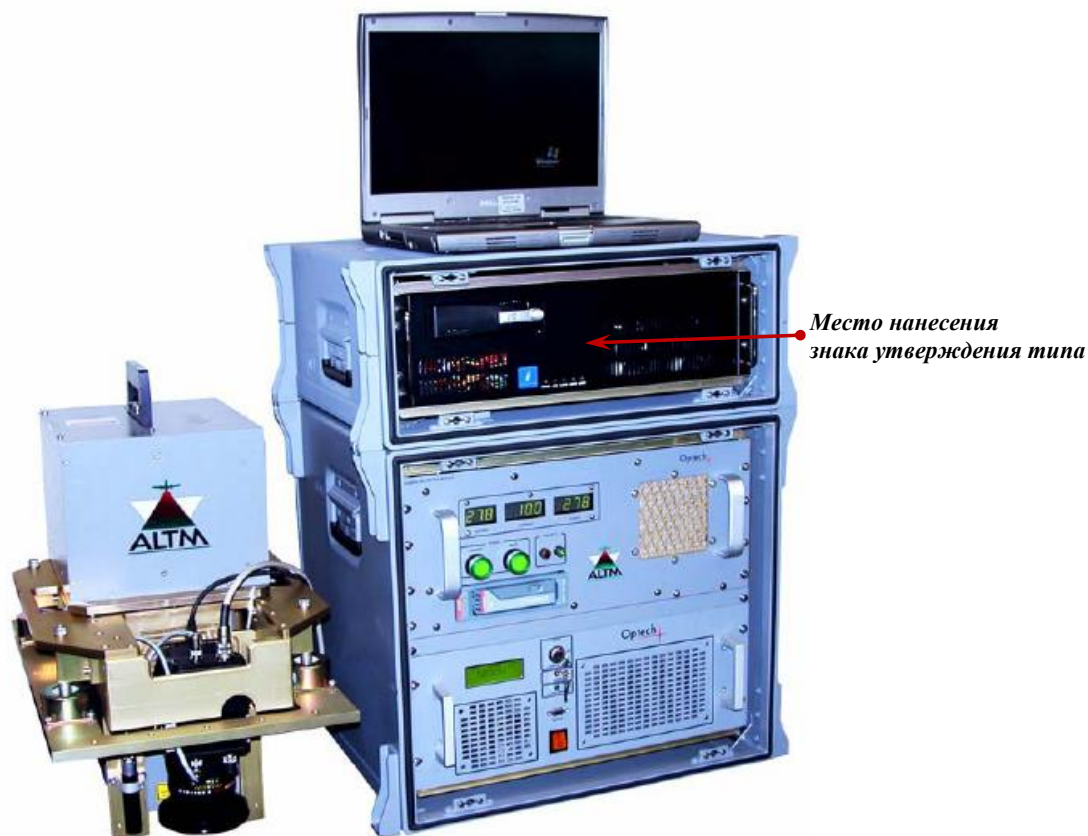
Рисунок 1 - Общий вид Системы (слева: сенсорный блок в сборе с аэрофотокамерой; справа: портативная ПЭВМ и стойка управления)
