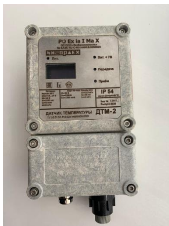
Рисунок 2 – Датчик температуры ДТМ исполнение ДТМ-2
