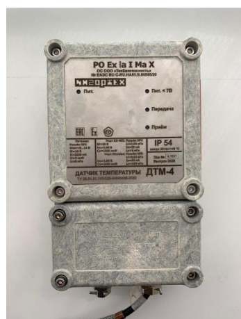
Рисунок 4 – Датчик температуры ДТМ исполнение ДТМ-4
