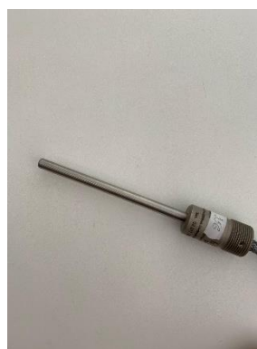
Рисунок 5 – Датчик температуры ДТМ исполнение ДТМ-П
