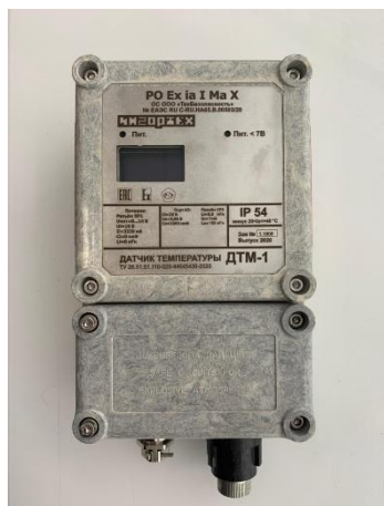
Рисунок 1 – Датчик температуры ДТМ исполнение ДТМ-1
