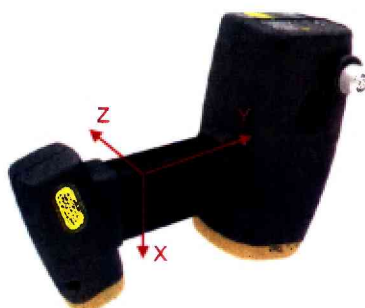
Рисунок 5 – Система координат лазерного сканера
