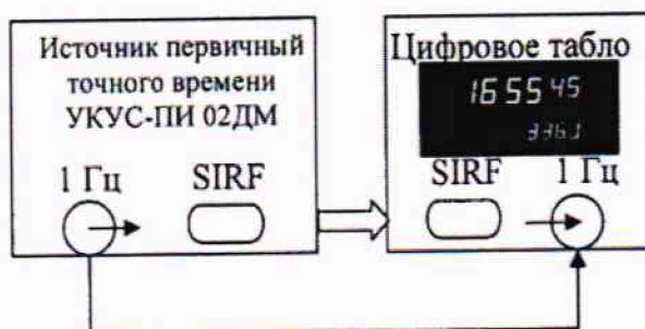
Рисунок 7 – Схема подключения УКУС-ПИ 02ДМ
