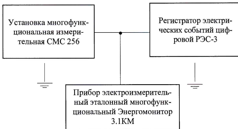
Рисунок 3 – Структурная схема определения погрешностей измерений мощности и коэффициента мощности
