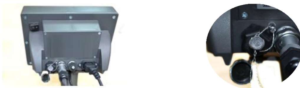
Рисунок 3 – Схема пломбировки приборов ТИТАН, обозначение мест нанесения знака поверки
