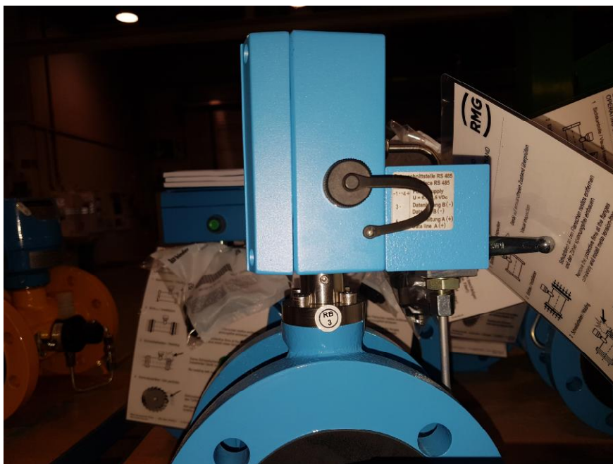
Рисунок 8 – Счетчик турбинный ТЕС 24. Место пломбирования
