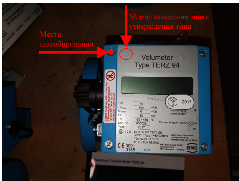
Рисунок 4 – Счетчик турбинный TERZ 94. Место пломбирования
