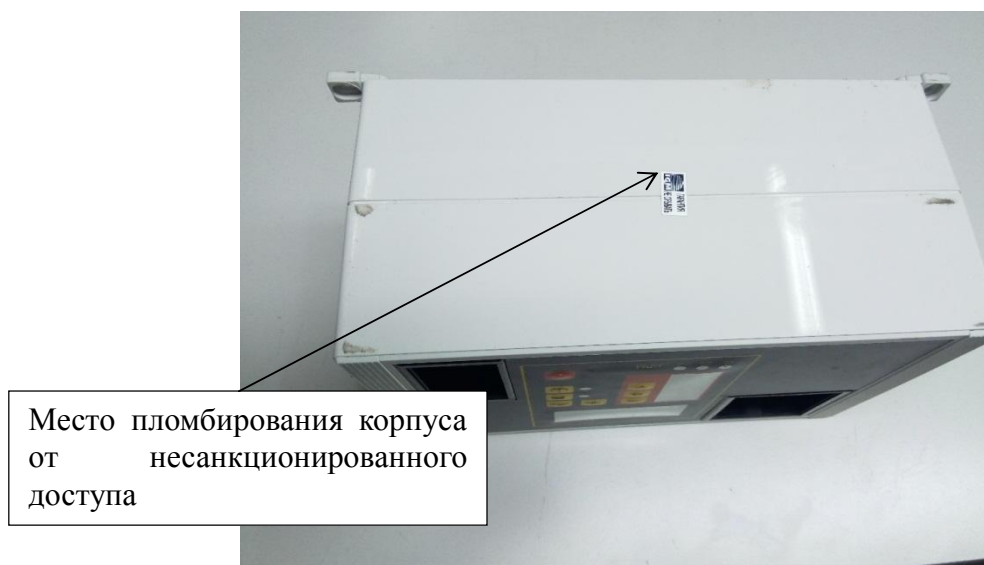
Рисунок 2 – Схема пломбирования газоанализаторов от несанкционированного доступа (модель 1011)
