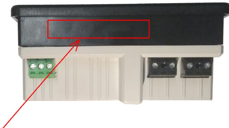
Рисунок 4 - Место нанесения знака поверки на модификацию UPM309 (вид справа)
