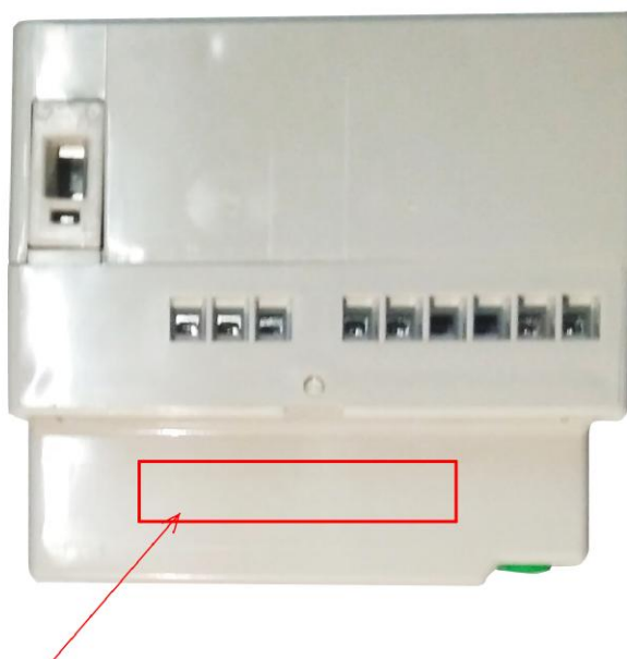
Рисунок 4 - Место нанесения знака поверки на модификацию UPM309 (вид справа)
