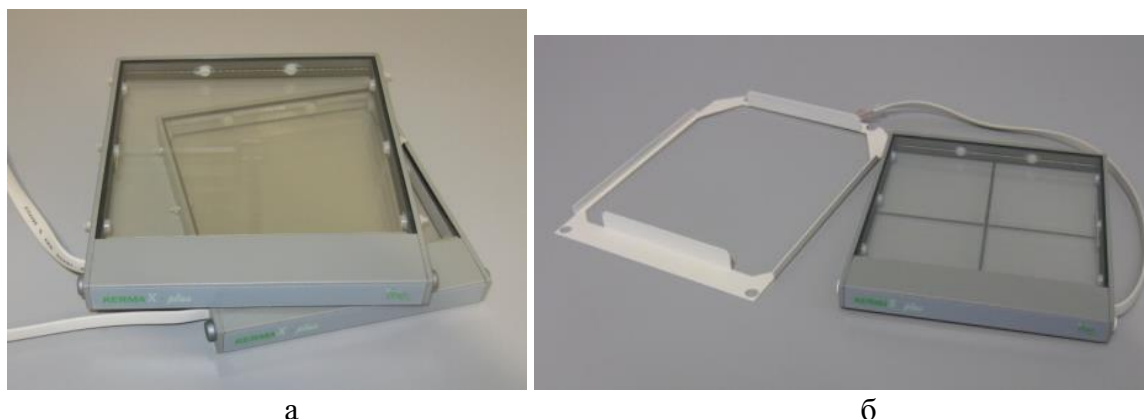
Рисунок 1 – Измеритель произведения дозы на площадь KermaX-plus 120-131: а – ионизационные камеры стандартного и компактного размеров; б – ионизационная камера с крестообразным элементом
