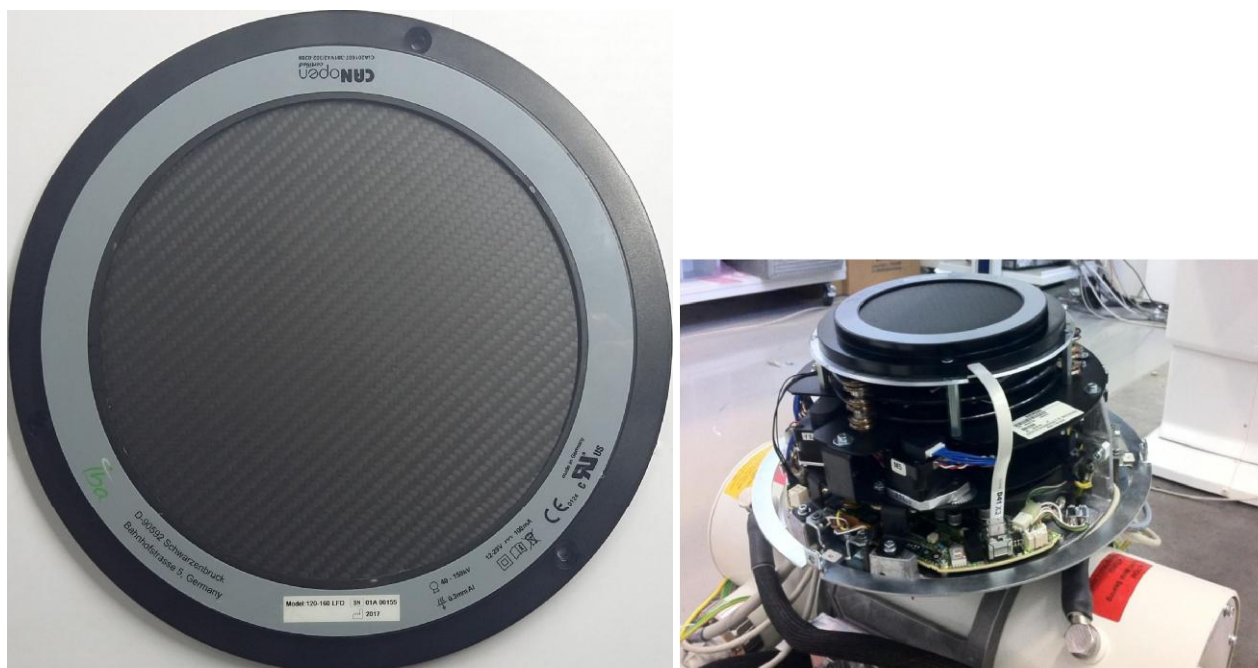
Рисунок 1 – Общий вид измерителя производства дозы на площадь KermaX plus 120-160 LFD (вид сверху и размещение на диафрагме коллиматора рентгенографической установки)
