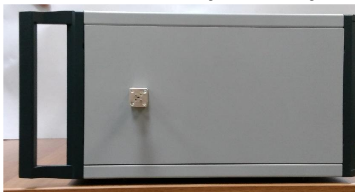
Рисунок 2 – Внешний вид блока измерительного. Боковая панель с СВЧ выходом
