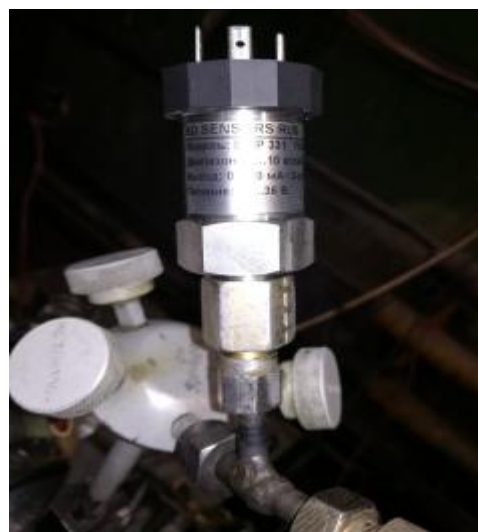
Рисунок 9 – Первичный преобразователь давления типа DMP в рабочем положении (с отсоединённым кабелем)
