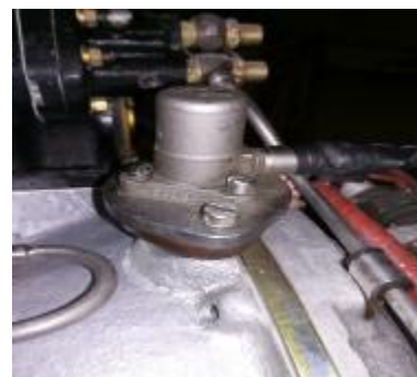
Рисунок 3 – Монтаж преобразователя вибрации MB-43-5B/0,35 на изделии
