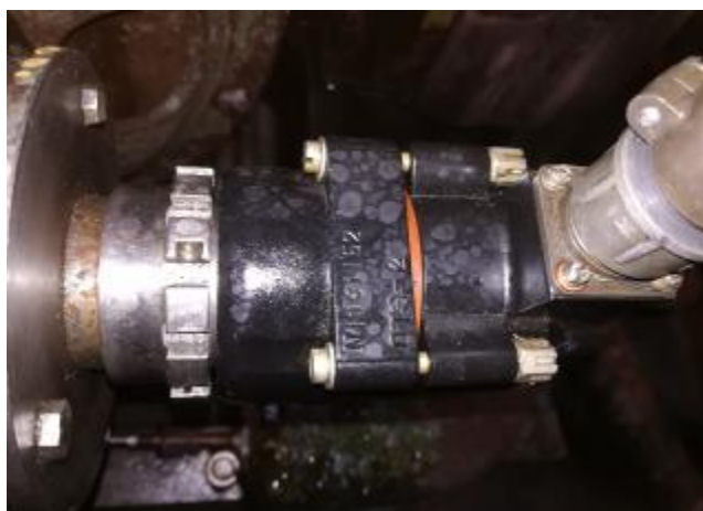
Рисунок 6 – Датчик тахометра ДТЭ-2 в рабочем положении (на гидротормозе)
