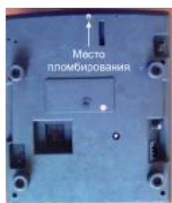
Рисунок 3 - Схемы пломбировки весов от несанкционированного доступа, обозначение места нанесения знака поверки
