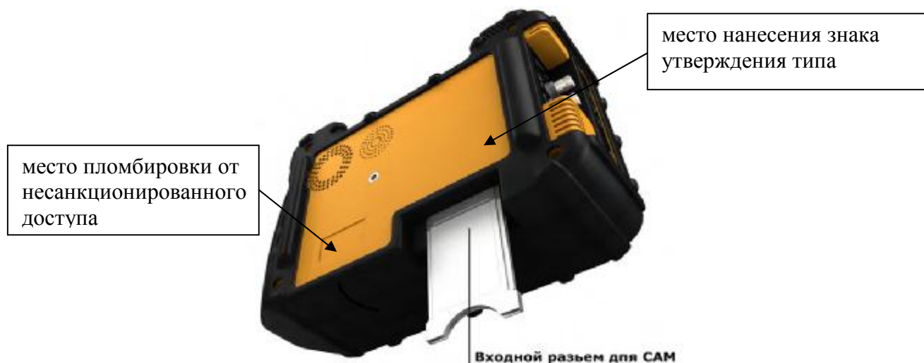
Рисунок 2 – Схема заводской пломбировки от несанкционированного доступа, обозначение места нанесения знака утверждения типа
