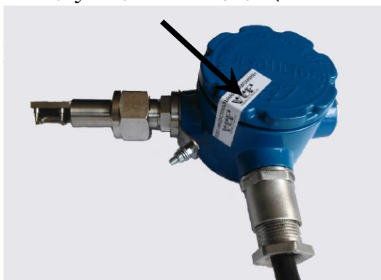
Рисунок 5 - Пример пломбировки ИПП системы "VARPRO-УЛЬТРАФЛОУ"
