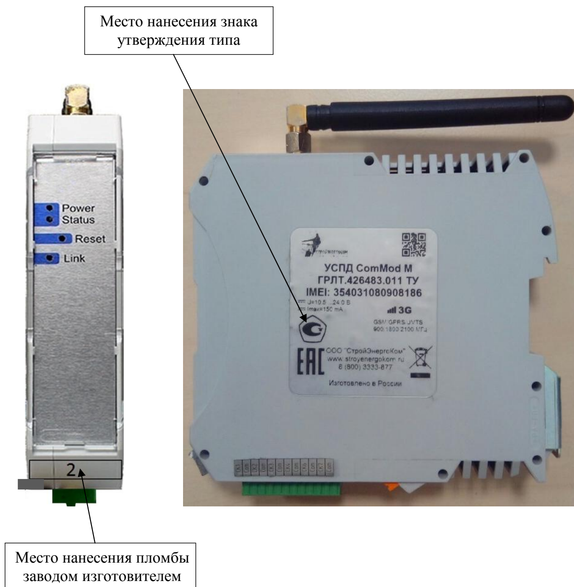
Рисунок 1 – Внешний вид средства измерений, схема пломбировки от несанкционированного доступа
