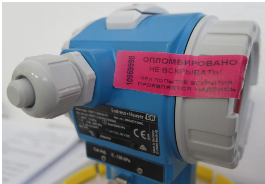
Рисунок 5 - Схема пломбирования корпуса преобразователя
