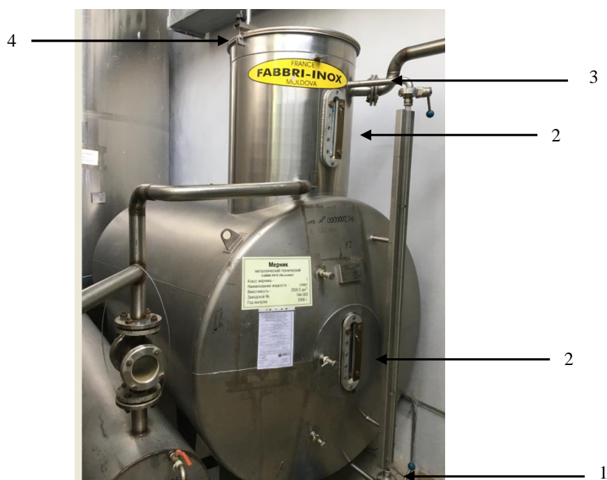
Рисунок 1 - Общий вид мерника металлического технического 1 класса ММТГ и схема пломбировки от несанкционированного доступа, обозначение места нанесения знака поверки
