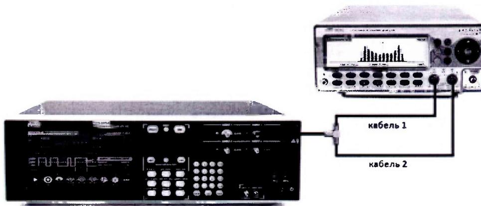
Рисунок 1 – Определение разницы задержки в измерительных кабелях
