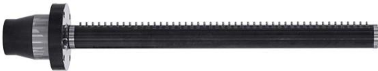
б) Мера цилиндр с выступами для крепления в силовом патроне
