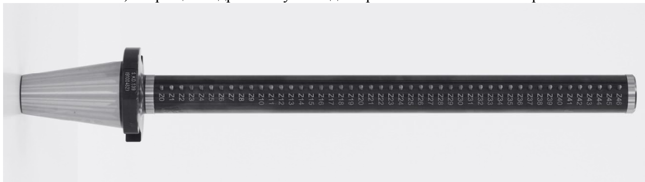
в) Мера цилиндр с выступами для крепления под конус шпинделя SK50
