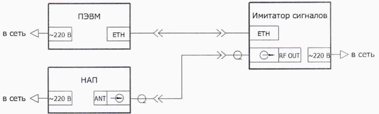
Рисунок 1 — Схема подключения имитатора сигналов для проверки работоспособности
