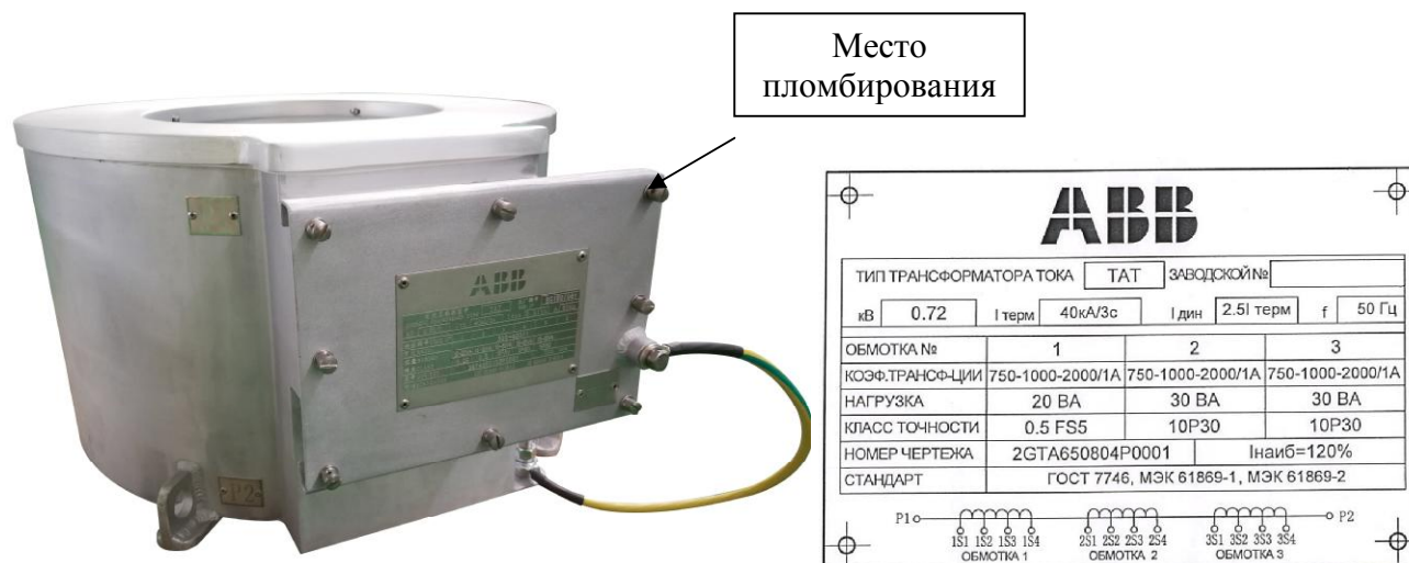
Рисунок 1 – Общий вид и место пломбирования трансформаторов тока встроенных ТАТ; вид таблички технических данных трансформаторов
