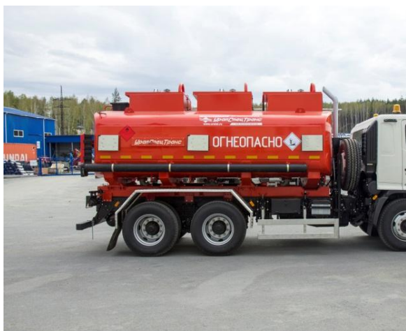
Рисунок 3 - Общий вид АТЗ с тремя секциями
