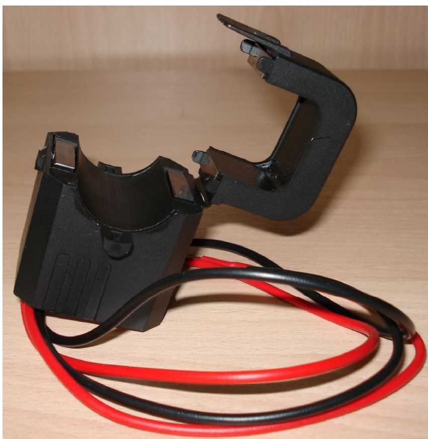
Рисунок 3 – Общий вид трансформаторов тока K UW2/40. Магнитопрод разомкнут
