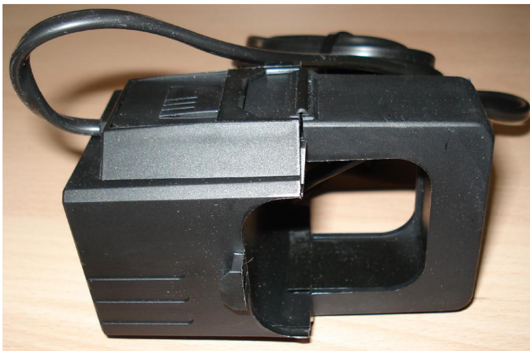
Рисунок 4 – Общий вид трансформаторов тока KUW4/60
