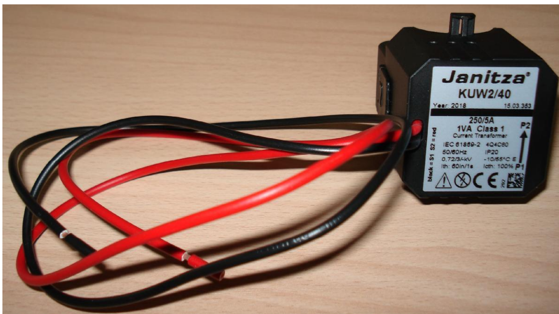
Рисунок 2 – Общий вид трансформаторов тока K UW2/40. Табличка технических данных
