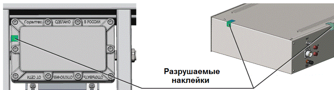
Рисунок 3 - Схема пломбировки блока АЦП и ТВР
