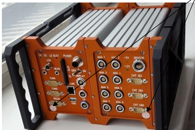
Рисунок 2 - Схема пломбирования блока управления (микроконтроллера) системы информационно-измерительной DAS-3 (вид спереди)
