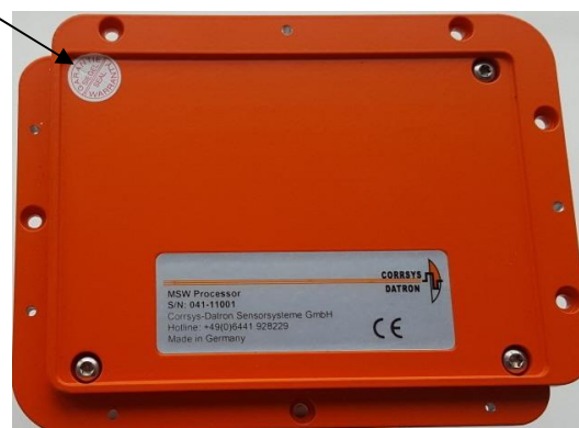
Рисунок 7 - Схема пломбирования процессора MSW рулевого колеса (вид сзади)
