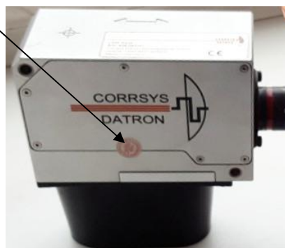
Рисунок 5 - Схема пломбирования оптического датчика L-350 Aqua
