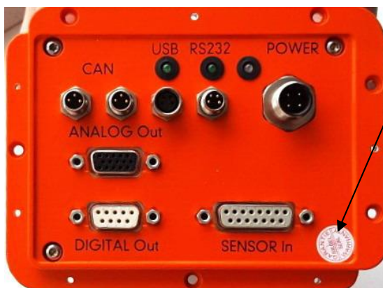
Рисунок 6 - Схема пломбирования процессора MSW рулевого колеса (вид спереди)
