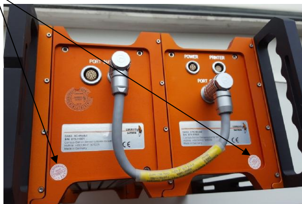
Рисунок 3 - Схема пломбирования блока управления (микроконтроллера) системы информационно-измерительной DAS-3 (вид сзади)
