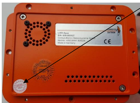
Рисунок 4 - Схема пломбирования электронного блока L-350 Aqua
