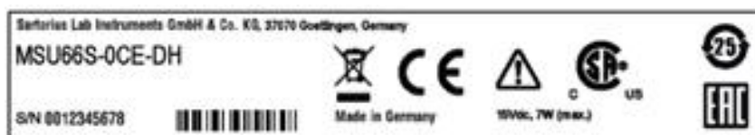
Рисунок 6 – Маркировка взвешивающего модуля (обозначение модификации весов)
