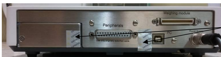
Рисунок 2 - Схема пломбирования от несанкционированного доступа модуля терминала
