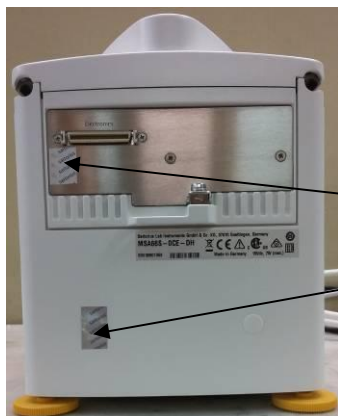
Рисунок 3 - Схема пломбирования от несанкционированного доступа взвешивающего модуля
