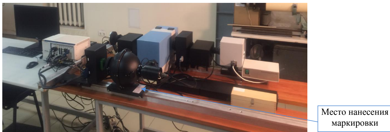
Рисунок 1 – Общий вид измерительного стенда для измерения параметров матрицы с межстрочным переносом с размером фоточувствительного элемента 7,4 мкм × 7,4 мкм «Фонон-3-Омега» ФРАЕ.468993.095
