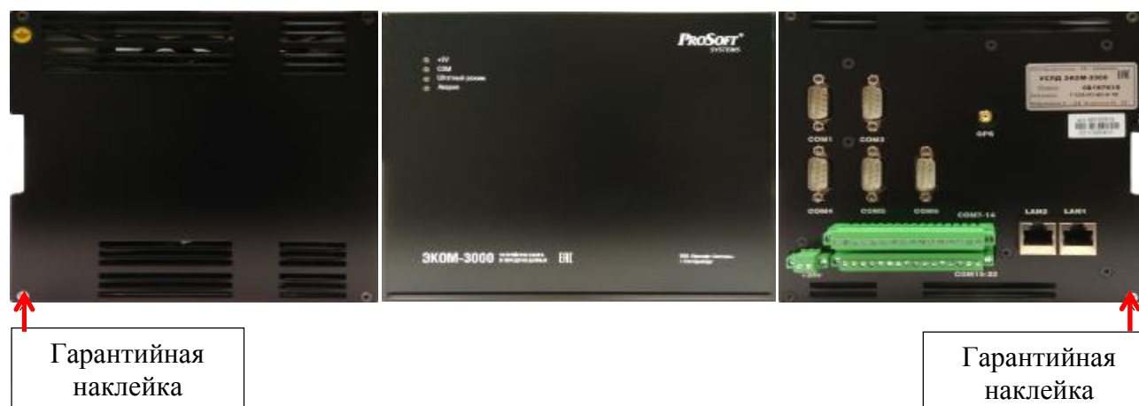
Рисунок 1 – Общий вид и схема пломбирования от несанкционированного доступа УСПД
