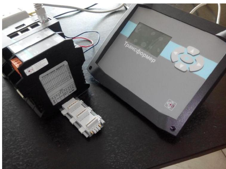
Рисунок 2 – Общий вид прибора Трансформер-SL, укомплектованного модулями А5-01, А5-01i, А8-0 или А8-0i, МВ, ИК5
