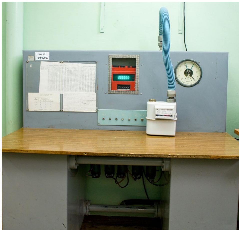
Рисунок 1 – Общий вид установки поверочной для счетчиков газа УПС-7,5
