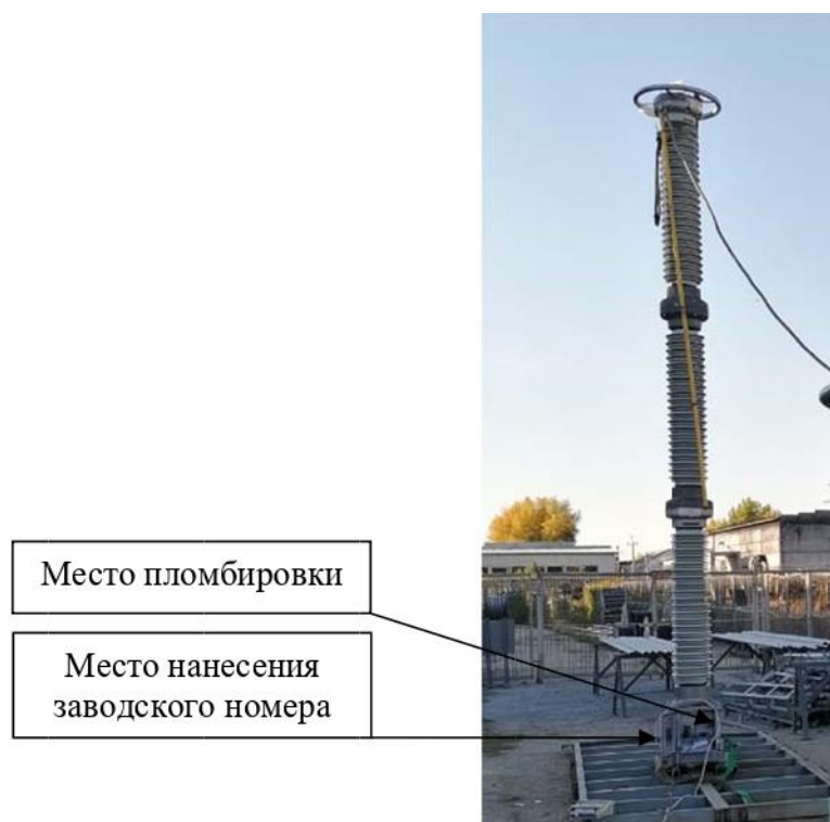
Рисунок 1 – Общий вид средства измерений с указанием места пломбировки, места нанесения заводского номера
