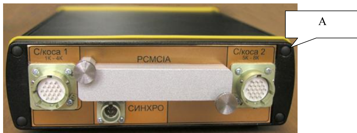
Рисунок 2 – Внешний вид задней панели средства измерений Места пломбировки от несанкционированного доступа (А)
