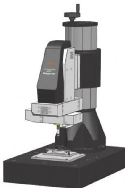
Рисунок 2 - Общий вид машин координатных измерительных консольных МАСН Ко-ga-me монтирующиеся на обрабатывающий станок
