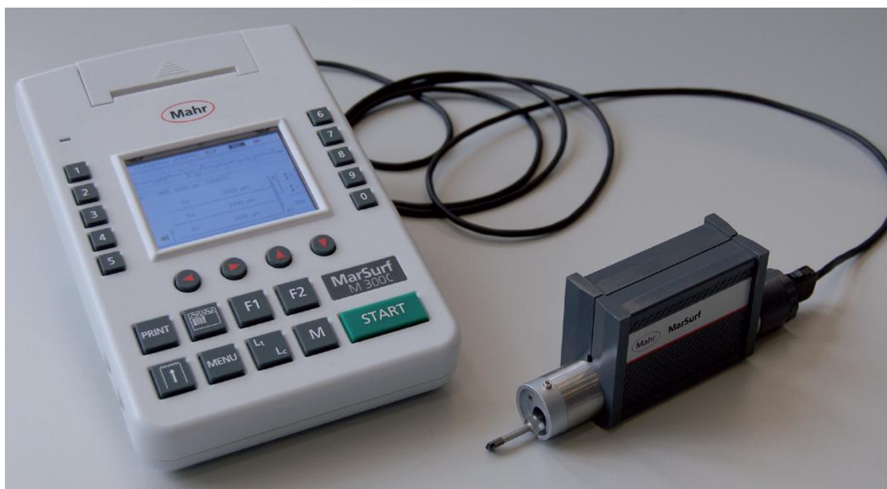
Рисунок 2 – Общий вид приборов для измерений параметров шероховатости поверхности MarSurf M 300 C
