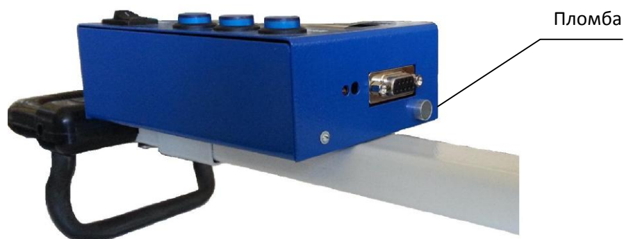
Рисунок 5 – Схема пломбирования ИСЛ-Н.01 от несанкционированного доступа
