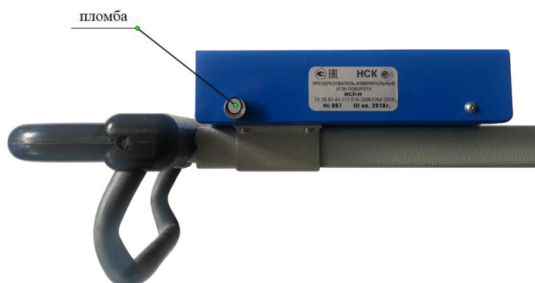
Рисунок 4 – Схема пломбирования ИСЛ-Н от несанкционированного доступа
