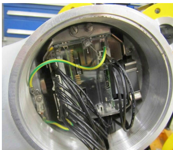
Рисунок 2б – Место установки пломбы завода-изготовителя (пломбировка отсека печатных плат)
