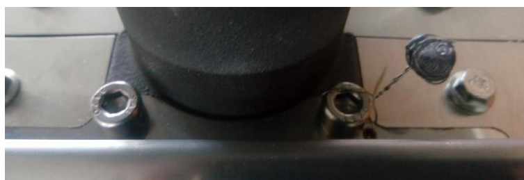
Рисунок 2а – Пломбировка основной маркировочной таблички пломбой завода-изготовителя
