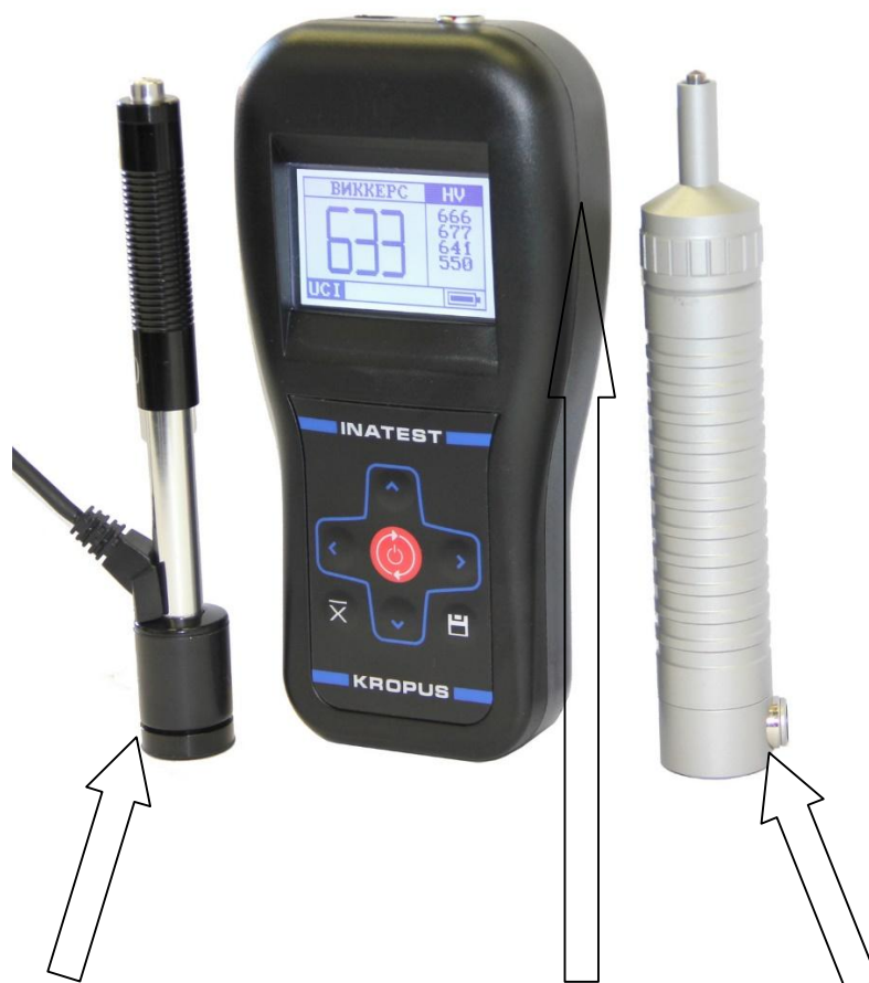
Рисунок 1 – Общий вид твердомеров с указанием места нанесения пломбы от несанкционированного доступа
