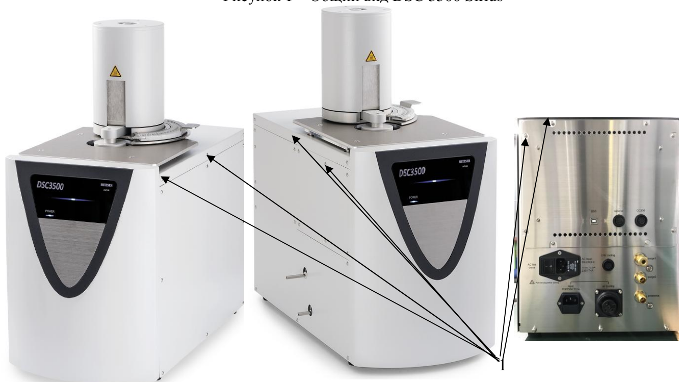
Рисунок 2 – Схема пломбировки от несанкционированного доступа calorimetра дифференциального сканирующего DSC 3500 Sirius 1 – замки на блоках управления calorиметров DSC 3500 Sirius
