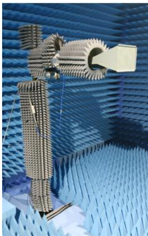
Рисунок 2 – Общий вид однокоординатного опорно-поворотного устройства AZ1000 с установленной антенной П6-59
