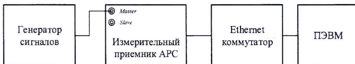
Рисунок 3. Схема подключения для проверки уровня избирательности, уровня спектральной плотности мощности фазовых шумов, динамического диапазона
