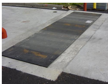
Рисунок 2 – Общий вид модуля ГПУ весов со специальным резиновым покрытием для предотвращения попадания воды и грязи в ГПУ
