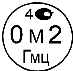
Рисунок 4.2. Знак поверки государственного научного метрологического института
